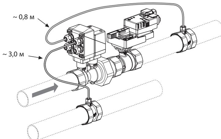
Для клапанов DN65...150 в комплект поставки входит погружная гильза. Датчик должен быть демонтирован перед установкой погружной гильзы, а затем установлен заново.
