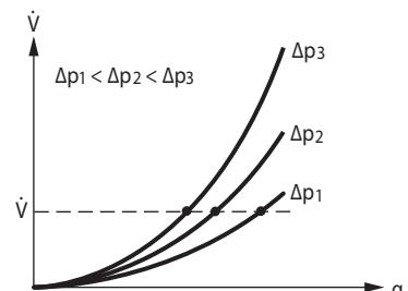
Требуемое текущее значение расхода  $V$  при изменении перепада давления на  $\Delta p$  обеспечивается изменением угла поворота  $\alpha$ .
