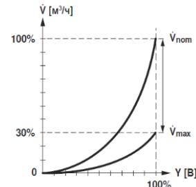
Производительность Q<sub>max</sub> это установленный в режиме управления мощностью максимальный выход тепла на теплообменнике
