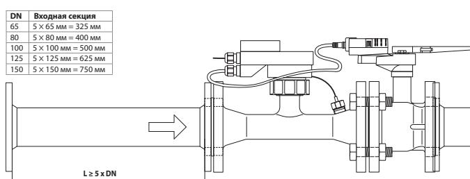
**Установка погружной гильзы и температурного датчика** Устройство оснащено двумя подключенными датчиками
