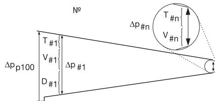
регулирующего клапана перепад давлений может увеличиться вплоть до величины  $\Delta P$  №1, степень регулирования при этом значительно снижается и расход теплоносителя по остальным веткам системы увеличивается непропорционально.
