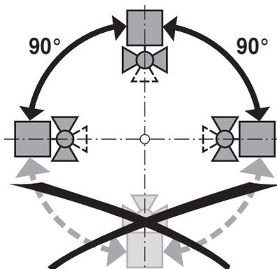
**Einbaulage im Rücklauf** Der Einbau im Rücklauf wird empfohlen.
